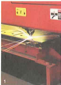
1. 板金加工には欠かせないレーザーによる 1 カutting 2. 機械・設備を板金と製缶に特 2 化した工場 3. パーソナルブランディング事 3 業では社員が自由にデザインできる。
